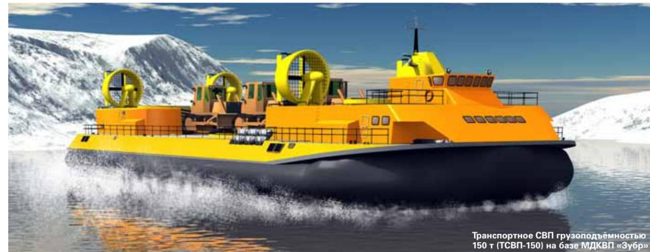
Транспортное СВП грузоподъемностью 150 т (ТСВП-150) на базе МДКВП «Зубр»
