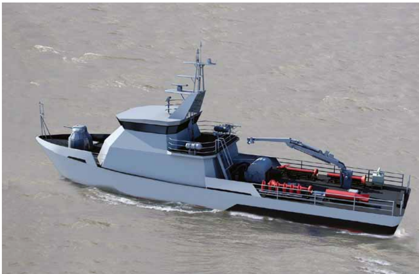
Проект высокоэффективного корабля ПМО ближней зоны полным водоизмещением около 150 т с габаритной осадкой 1,80 м.
