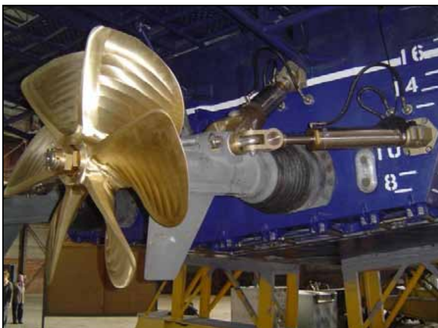
Рис. 2. Подъемно-поворотные приводы с частично-погружными гребными винтами в составе катера
