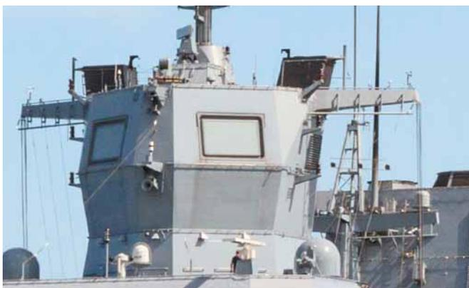
Рис. 2. Внешний вид многофункциональной РЛС с АФАР TRS-4D компании Cassidian/EADS на фрегате ВМС Германии пр. 125
