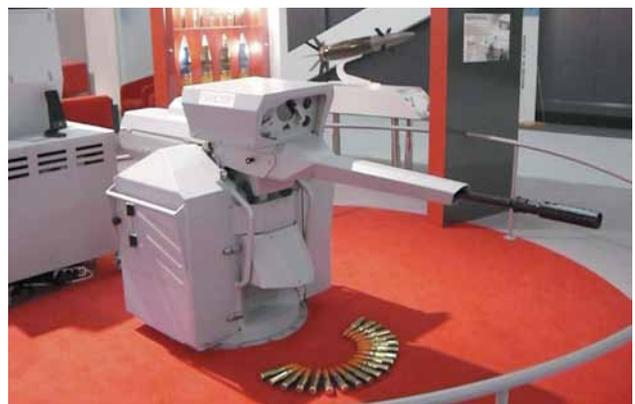
Рис. 3. Роботизированная 20-мм артиллерийская установка Narwhal 20A компании Nexter. Устанавливается на УДК «Mistral» и фрегатах FREMM ВМС Франции
