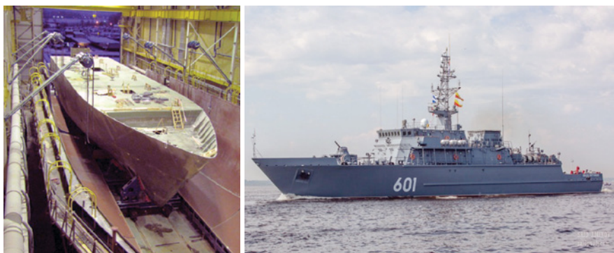
Рис. 5. Корабль ПМО пр. 12700 из полимерных композитных материалов
