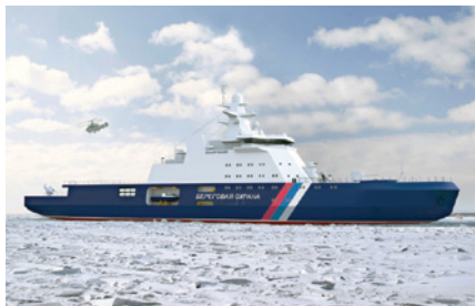
Рис. 6. Пограничный корабль ледового класса Arc7 с высоковольтной системой электродвижения
