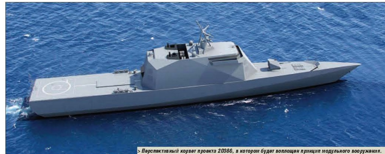
Перспективный корвет проекта 20386, в котором будет воплощен принцип модульного вооружения.
