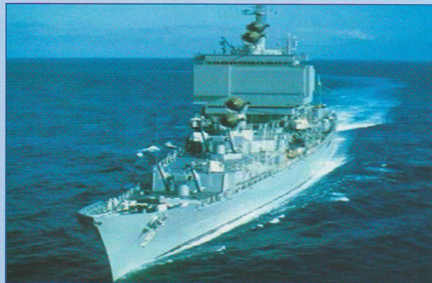
Рис. 2. РЛС на неподвижных ФАР
