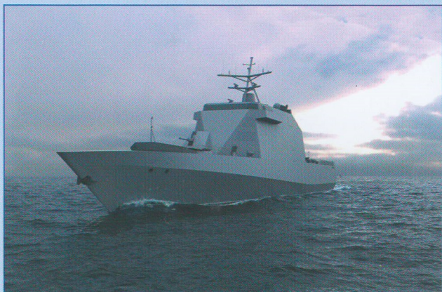
Рис. 7. АФАР для кораблей меньшего водоизмещения (под ходовым постом)
